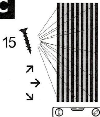
Os painéis podem ser montados na parede com parafusos ou com cola. Para montagem no teto devem ser sempre utilizados parafusos.
