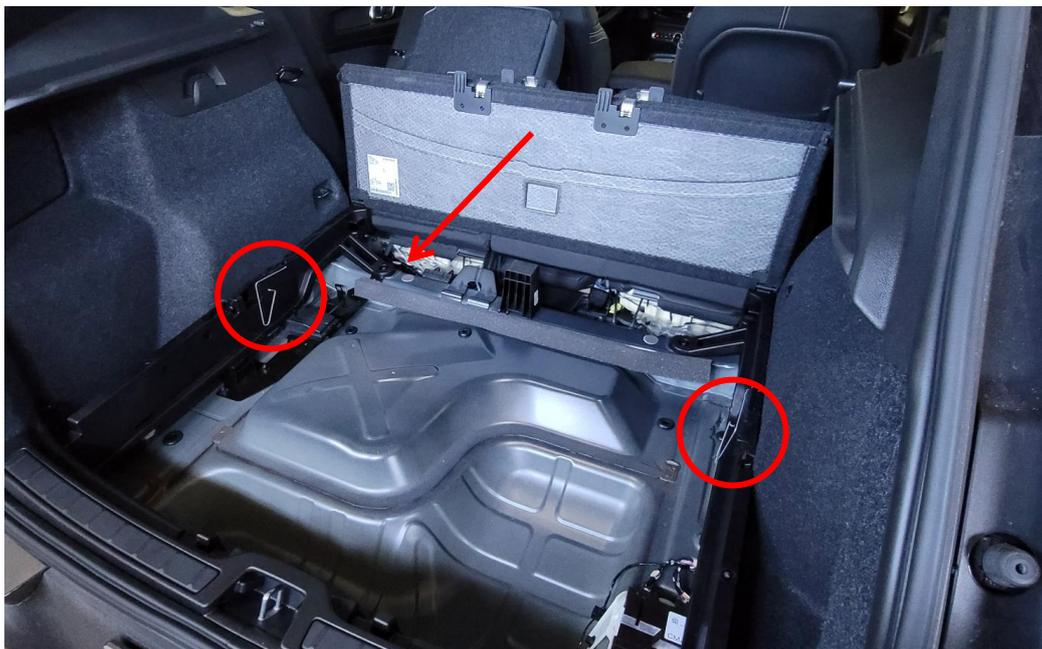
Baixe os encostos dos bancos traseiros, levante o piso de carga e retire os cliques de retenção metálicos dos respectivos orifícios e ranhuras de cada lado. É muito fácil de fazer. Em seguida, incline todo o piso de carga para cima, como mostra a primeira fotografia.
